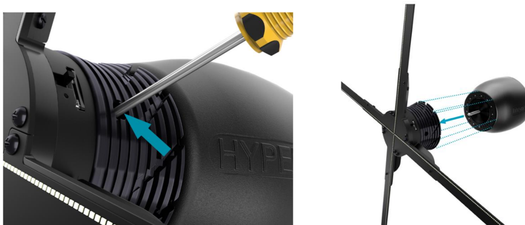
Fig 44. Retrait de la vis de serrage et du rotor de l'arbre
