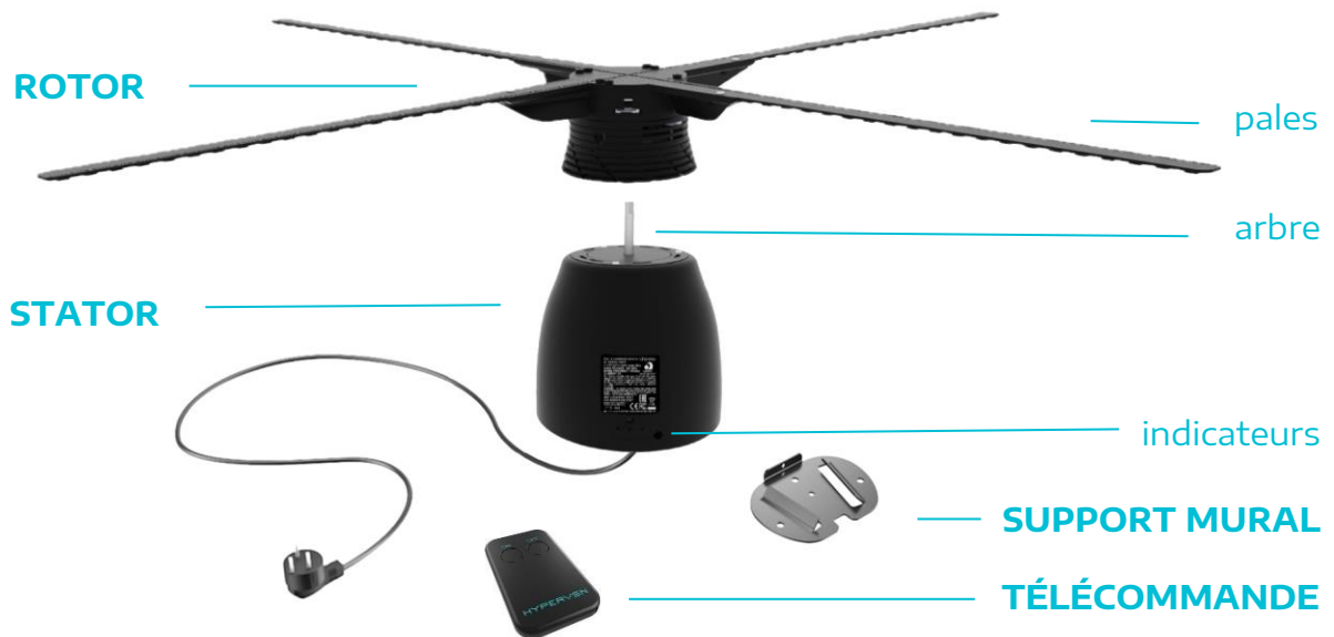
Fig 2. Principaux éléments de l'appareil et télécommande
