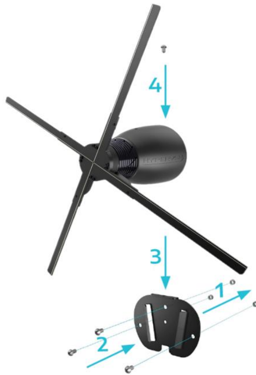
Fig 10. Montage mural de l'appareil
